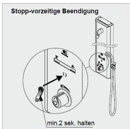
Die **kurze Stopp-Funktion** für z.B. Reinigungszwecke kann entweder über den mitgelieferten Magneten aktiviert bzw. gestoppt werden oder über die App eingestellt und aktiviert bzw. gestoppt werden.
